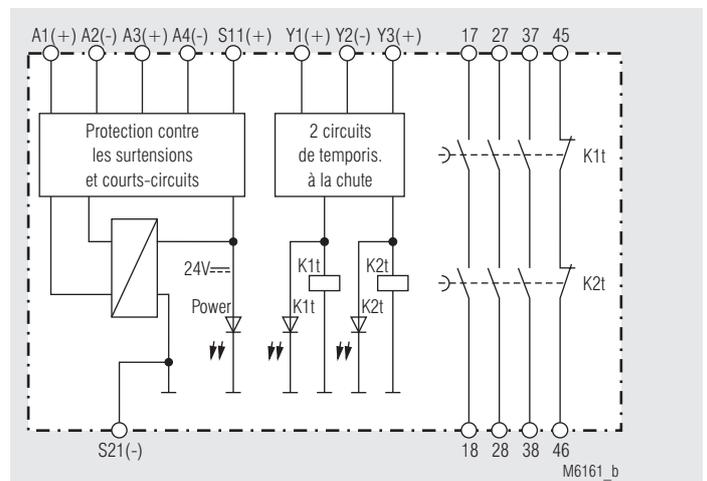
Schéma-bloc pour exécutions avec 2 circuits de temporisation. Sur la version avec un seul circuit, K2t disparaît.
